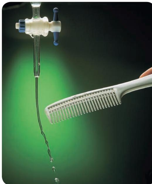
O filete de água\* desvia-se da vertical ao ser atraído por um pente plástico previamente eletrizado por atrito com um pedaço de flanela eletrostática.
