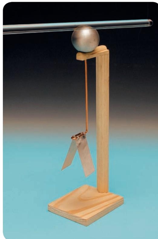
📌 **Quando o bastão eletrizado por atrito com uma flanela é aproximado da esfera do eletroscópio, as folhas metálicas se abrem. Elas se repelem porque adquirem (por indução) cargas de mesmo sinal que o bastão.**
