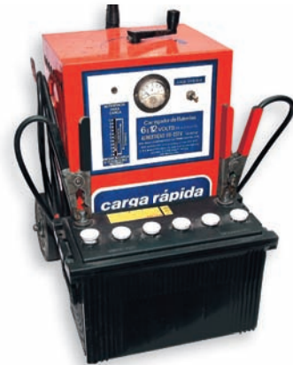
▶ Enquanto é recarregada num autoelétrico, a bateria funciona como um receptor.
