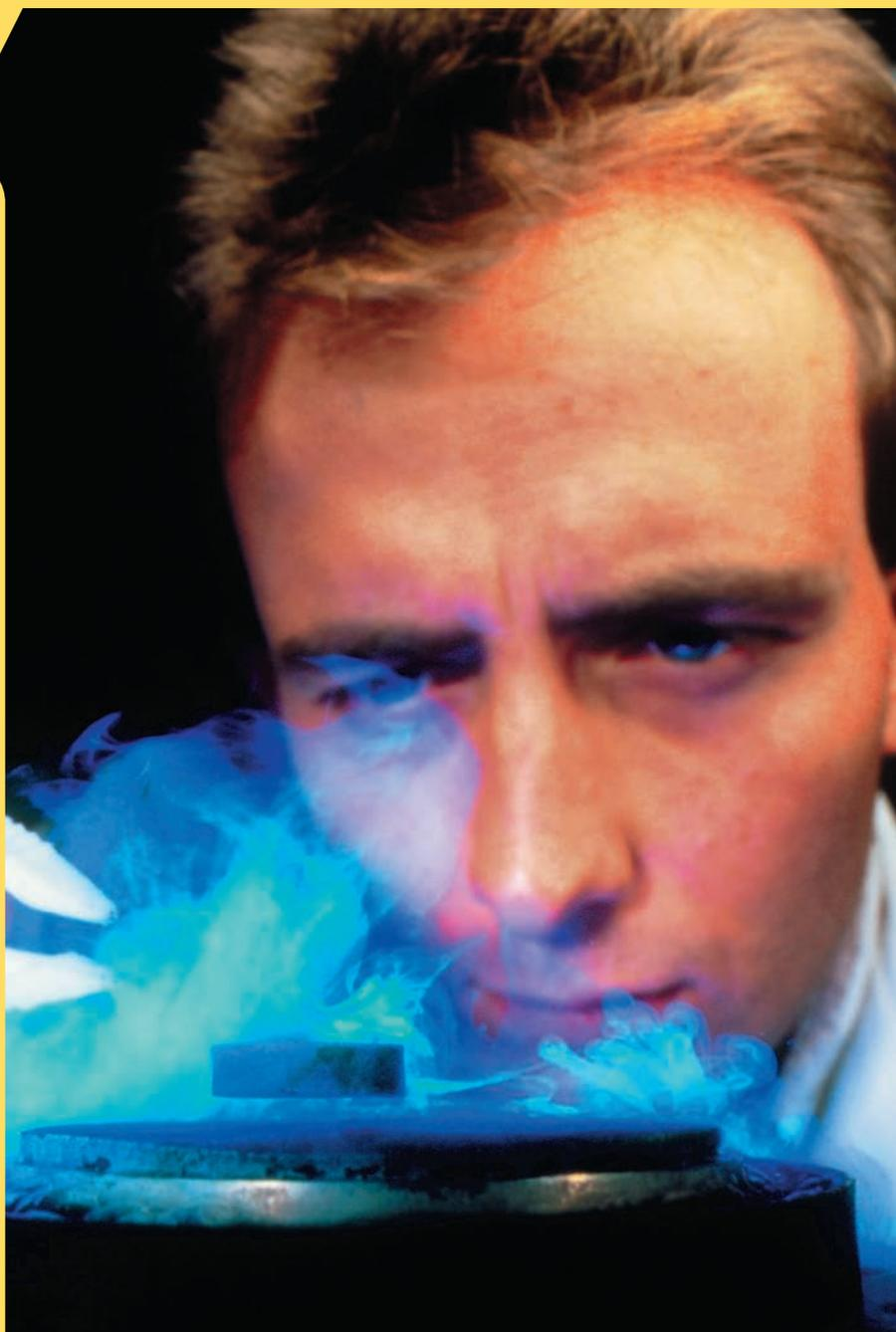
Um pequeno ímã flutuando sobre um supercondutor, devido ao campo magnético criado pela corrente elétrica induzida no supercondutor em consequência da aproximação do ímã.
