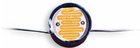
▶ Resistor fotossensível: sua resistência elétrica varia conforme a incidência da luz.
