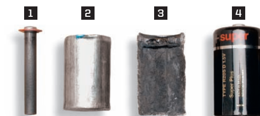
[1] cilindro de carvão; [2] invólucro de zinco; [3] vista em corte; [4] a pilha inteira.
