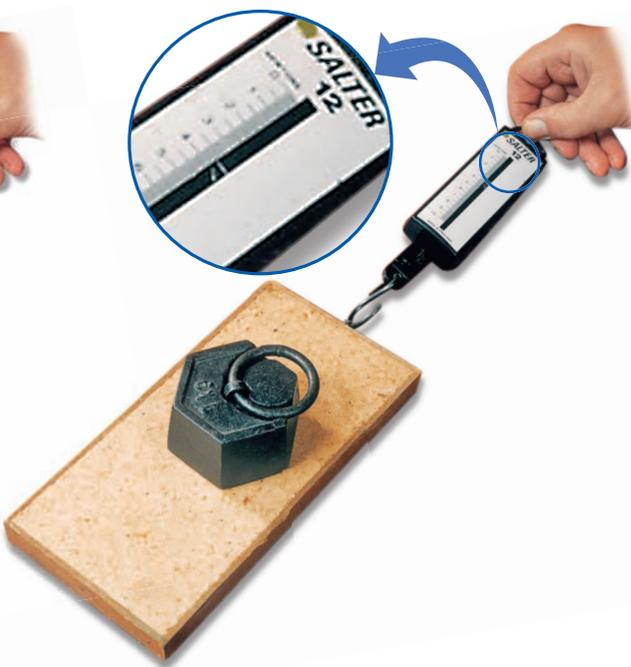
▶ Ao colocar a carga sobre a placa, para que seu movimento continue uniforme, a intensidade da força aplicada pelo operador passa para 3,7 N. Isso significa que a intensidade da força de atrito aumenta, pois aumenta a intensidade da força normal que a mesa exerce na placa.
