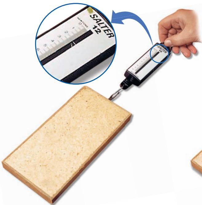
▶ A força aplicada pelo operador sobre a placa de madeira desloca-a em movimento uniforme. A força de atrito dinâmico tem intensidade igual à da força aplicada pelo operador e que é indicada pelo dinamômetro: 2,2 N.
