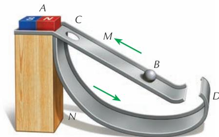
◀ Máquina de movimento perpétuo proposta em 1670, por John Wilkins, bispo de Chester: a esfera de ferro B sobe a rampa M, atraída por um ímã A, atinge o buraco C e desce pela rampa N. Devido à curva em D, a esfera retorna à rampa M, e o movimento "repete-se indefinidamente". Onde está a impossibilidade prática desse dispositivo?
