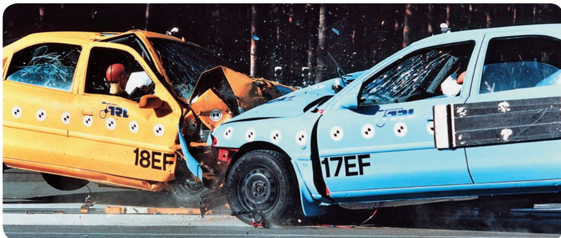
▲ Teste de colisão frontal entre dois carros, cada um a 56 km/h. A filmagem do impacto pode ser usada para melhorar o design dos veículos e a segurança nas estradas.
