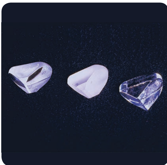
As três fases da fabricação de um prisma de reflexão total: prisma bruto, lapidado e acabado.
