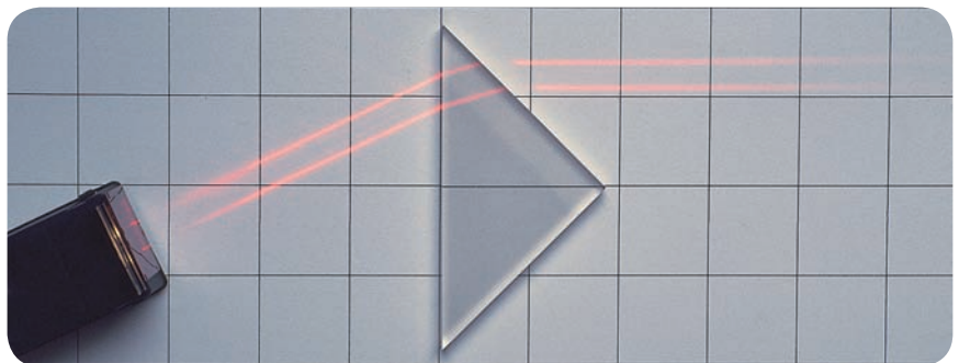
▶ Trajetória da luz ao atravessar um prisma de vidro imerso no ar.
