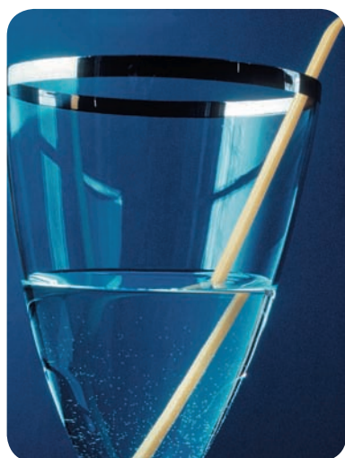
Figura 2. O canudo colocado obliquamente em relação à superfície do líquido parece estar quebrado.
