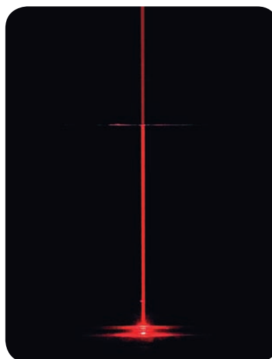
Incidência normal: a refração ocorre sem desvio.
