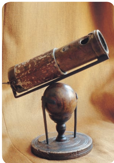
Réplica do segundo telescópio de reflexão projetado e construído por Isaac Newton, em 1671.
