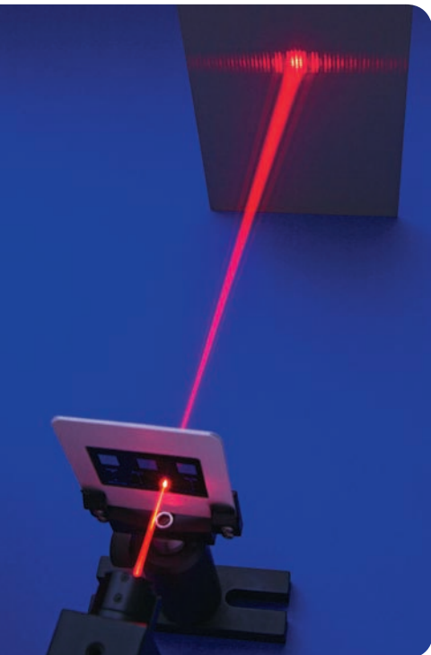
Laser incidindo sobre uma rede de difração, gerando franjas de interferência em um anteparo.
