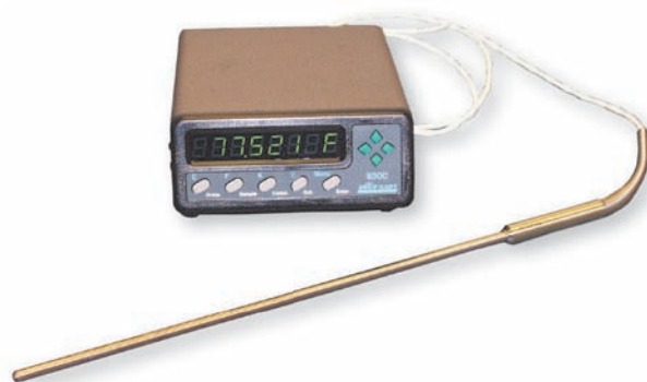
▶ No termômetro de platina, a grandeza termométrica é a resistência elétrica.
