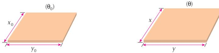
Figura 7. O aumento da temperatura acarreta aumento das dimensões lineares da placa e, portanto, de sua área.
