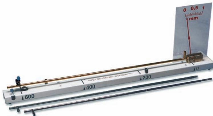
◀ O dilatômetro da figura destina-se à medição da dilatação linear de barras metálicas de diferentes materiais.
