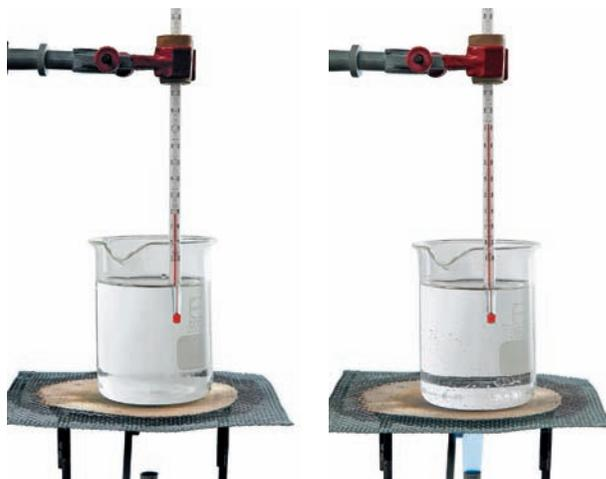
◀ A dilatação da substância termométrica (neste caso, o álcool) constitui o princípio de funcionamento dos termômetros de coluna líquida.
