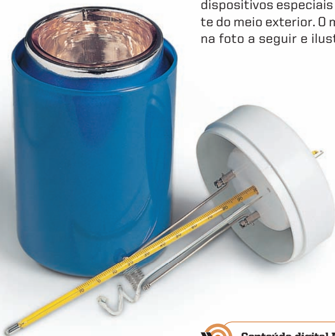
Figura 7. Corte de um calorímetro de mistura.
