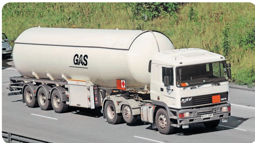
▶ Transporte de gás liquefeito, em cilindro de alta pressão.
